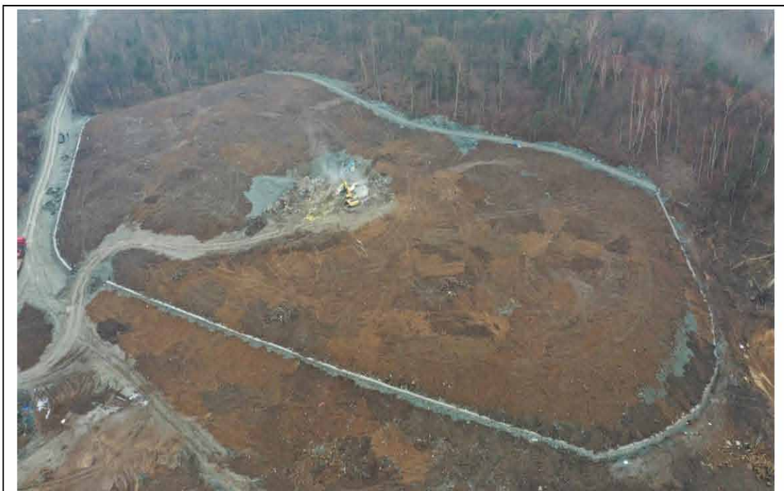
龙蒲4标 K87+000 甄峰岭1号隧道出口弃渣场,弃渣前根据扰动范围设置挡渣墙,弃土结束后,对渣体实施了全面整地,表土回覆和乔灌木栽植绿化等措施。
