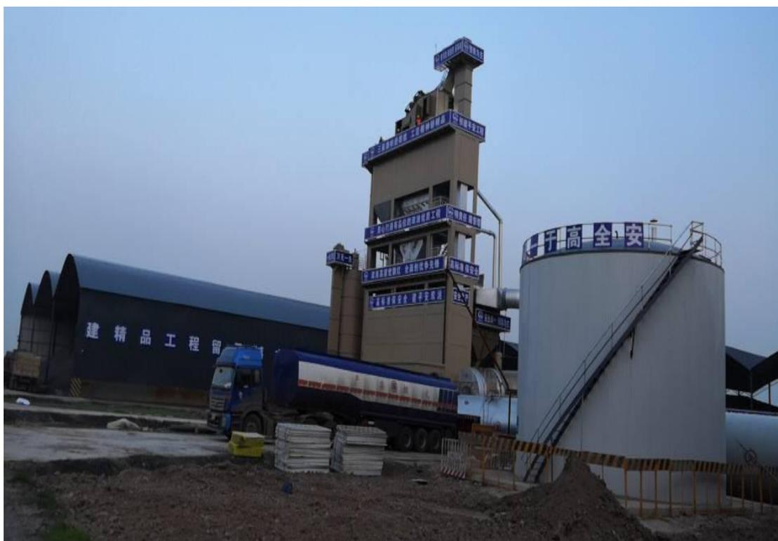
以电源加热底油，以循环的热底油加热沥青，进行物料混拌，沥青加热为封闭设备，基本上不产生沥青烟气。
